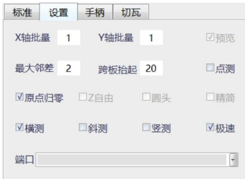
6、原点归零： 时，在开始测量前，数控系统中 XYZ 工件坐标必须为 0。
